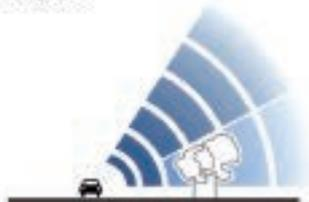
Il verde non è utilizzato al solo scopo di arricchire e delimitare le aree di progetto. Disposto in filari, trasversalmente alla direzione di scorrimento del traffico, può intercettare e smorzare le onde acustiche delle autovetture, creando delle migliori condizioni ambientali.
