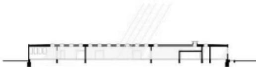
SCHEMA ESPOSIZIONE SOLARE GIUGNO ORE 12:00
