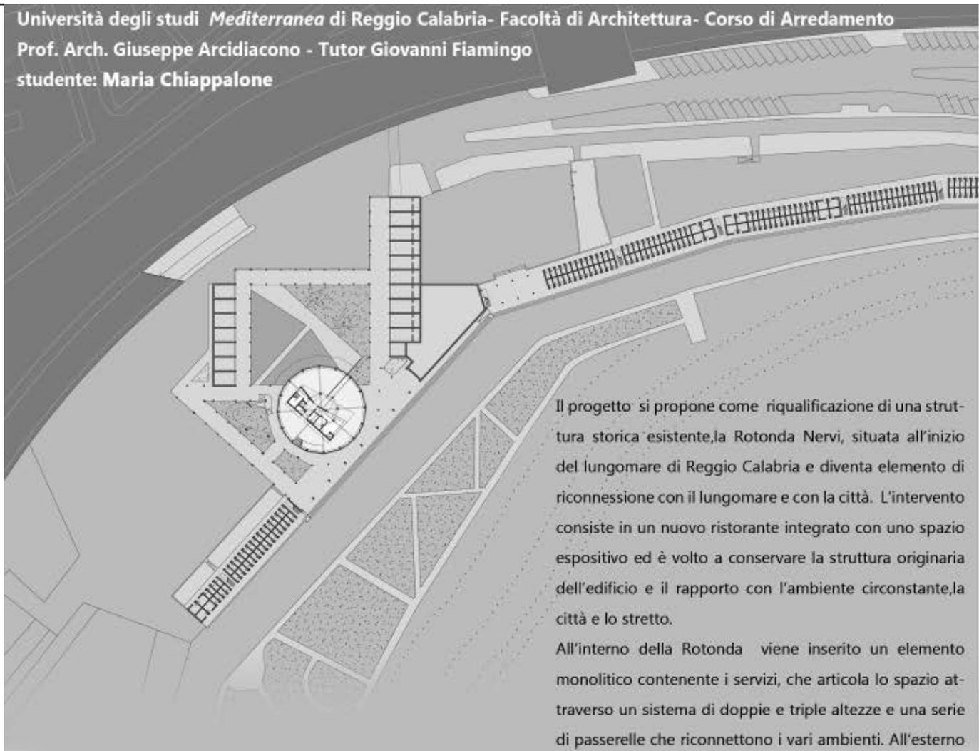
Il progetto si propone come riqualificazione di una struttura storica esistente, la Rotonda Nervi, situata all'inizio del lungomare di Reggio Calabria e diventa elemento di riconnessione con il lungomare e con la città. L'intervento consiste in un nuovo ristorante integrato con uno spazio espositivo ed è volto a conservare la struttura originaria dell'edificio e il rapporto con l'ambiente circostante, la città e lo stretto.
