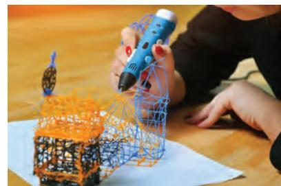
fig. 10 - Penna, matita ad estrusione per il disegno libero in 3D
