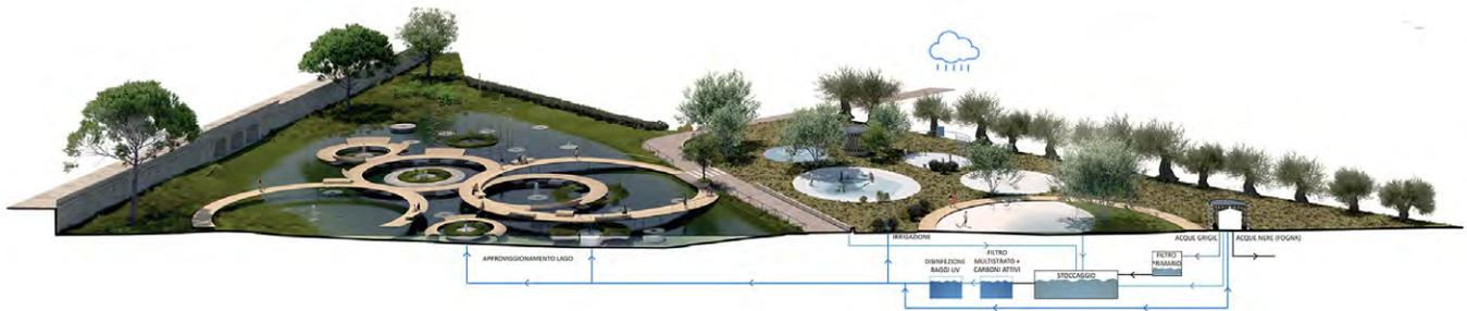
Sezione prospettica che evidenzia il sistema di raccolta e reintegro delle acque
