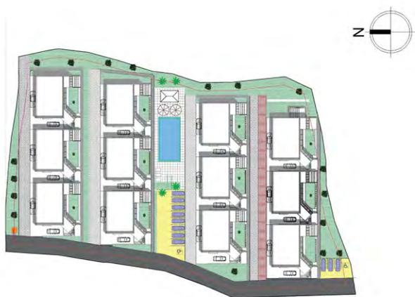
Planimetria generale del progetto: tre schiere di case parallele alle curve di livello
