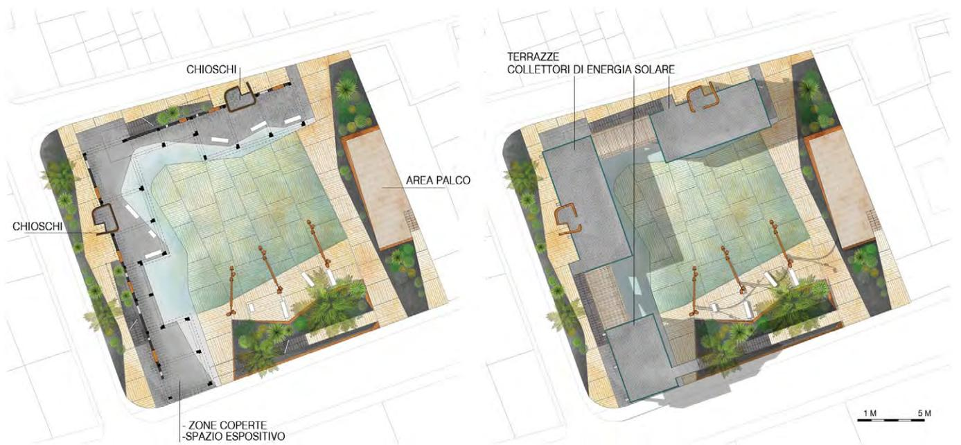
Un sistema di quinte che si pone in relazione con l'immediato intorno, integrandosi con la morfologia urbana. Il muro e le terrazze sono i nuovi margini fisici del progetto, con una geometria volutamente rigida. Al contrario la piazza vera e propria assume linee più libere e mimetiche con il paesaggio dell'isola.
