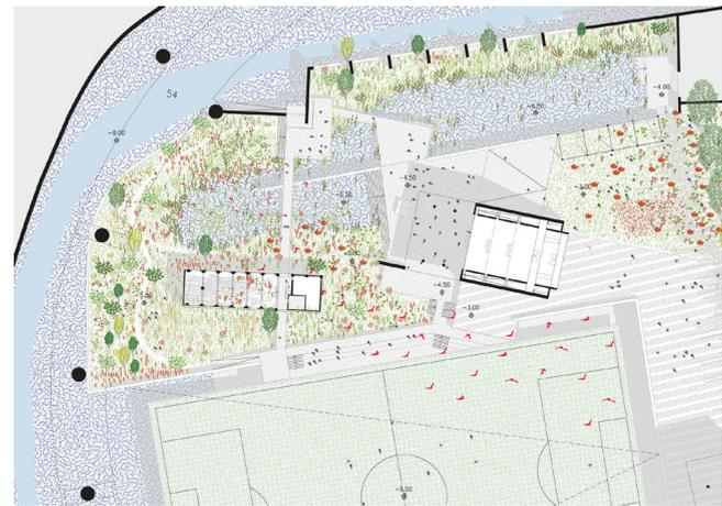
Pianta attacco a terra - Stralcio dell'area a Nord a ridosso del corso d'acqua. Il sistema progettato con l'area verde inondabile e il bacino di contenimento al di sotto del campo da calcio
