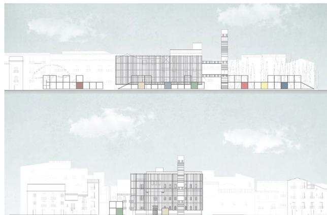
Sezioni architettoniche di progetto, nelle quali è possibile denotare i moduli con funzione di street art e l'ex convento rivestito da lamiera in alluminio stirato, affiancato da una torre panoramica
