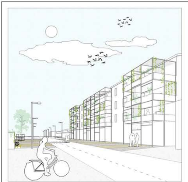
SOCIAL HOUSING | La facciata dell'edificio confiscato assume una nuova veste attraverso la sovrapposizione di una pelle che accoglie verde rampicante e sistemi di ombreggiamento.
